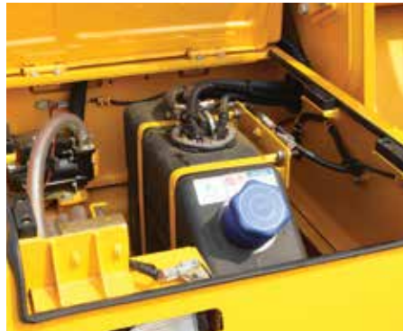
POMPA NAPEŁNIANIA PALIWA
