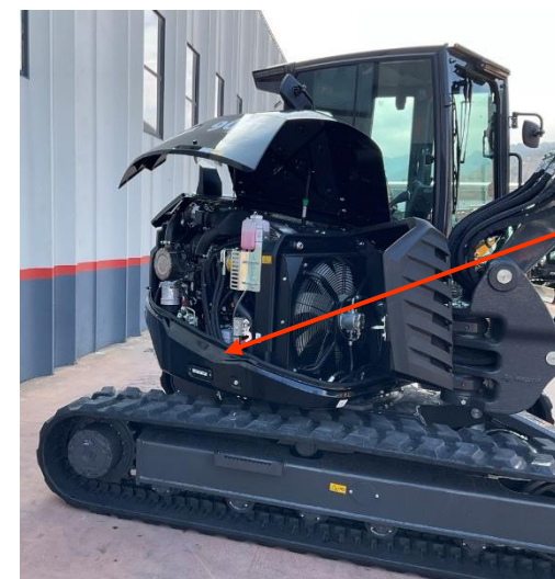
FAN DRIVE – Viskolüfter Kühlsystem (mit automatischer Invertierung )
